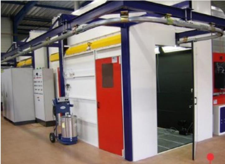
Les normes Aéronautique, Ferroviaire, et industrielles imposent parfois certains Contrôles Non Destructif . L'Opération de Ressuage (application de pénétrant, rinçage, séchage, et application de révélateur) se réalisent dans des cabines spécifiques
