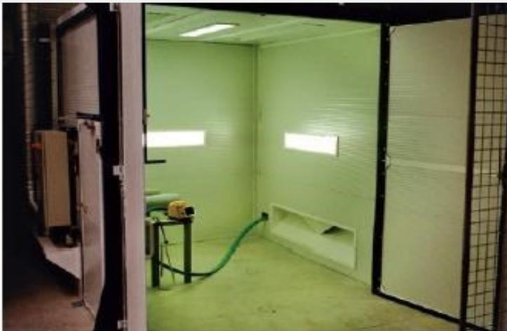
L'opération de Métallisation est une projection de ZINC ou d'ALUMINIUM à chaud. Les particules fondues sont très nocive pour la santé et nécessitent d'être réalisé dans un espace ventilé et sécurisé. Les Cabines de Métallisation permette un travail en toute sécurité, et sans dépôt de poussières pendant la projection
